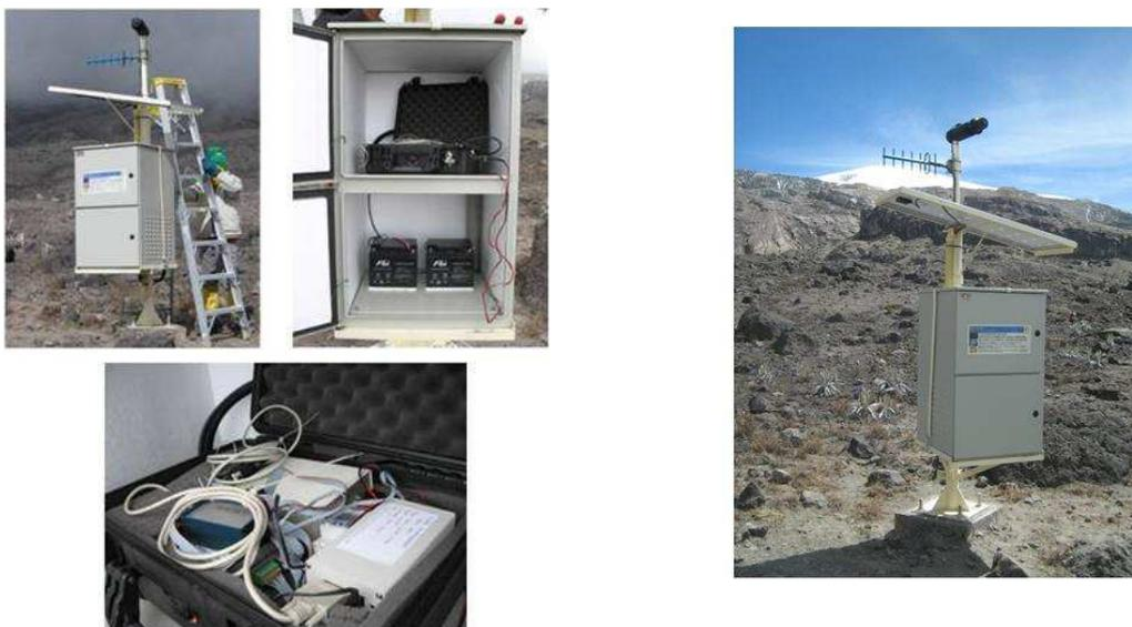
Figura 1.19. Instrumentación de una estación SCAN DOAS para el monitoreo de SO<sub>2</sub> en el VNR.
